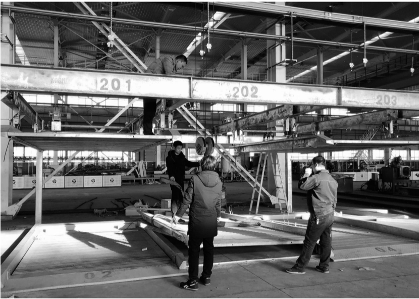
近日,庆通公司在和盛工业园区机械制造装备基地加班加点进行立体车库升降横移式2层5车位样机安装。图为技术人员在安装作业。(马鑫 摄)
